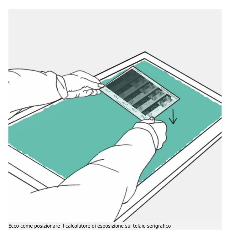
Ora sviluppa il telaio. Le diverse aree del calcolatore di esposizione, con le diverse gradazioni di grigio, reagiranno in maniera diversa allo sviluppo: in alcune aree l'emulsione verrà completamente lavata via, in altre non si staccherà.
